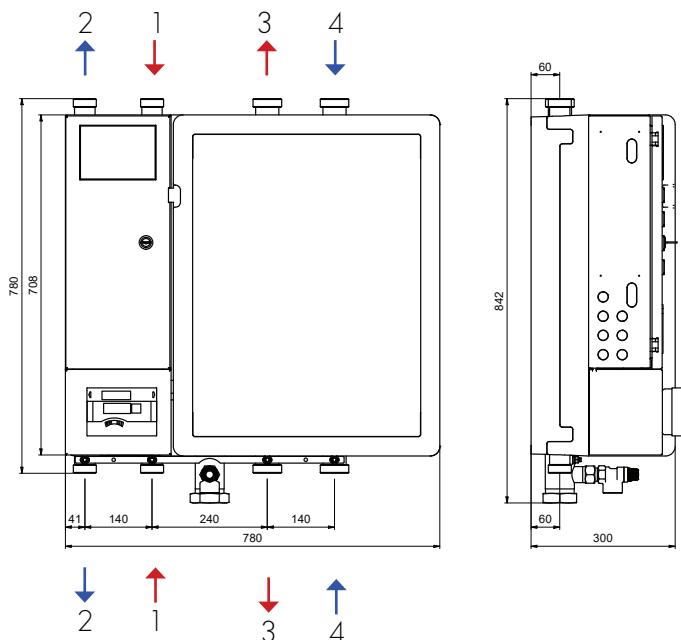
Die Baureihe aqoClick-L ECO stellt die erweiterte Ausführung der aqoClick-s ECO dar und verfügt über eine höhere Leistung von 30 bis zu 155 kW. Die Stationen haben sowohl oben als auch unten primäre und sekundäre Anschlüsse, was einen vielseitigen Einsatz gewährleistet. Auf Wunsch können auch Regler anderer Hersteller verwendet werden.
